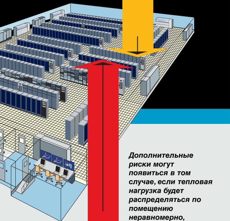
**Дополнительные риски могут появиться в том случае, если тепловая нагрузка будет распределяться по помещению неравномерно, образуя "горячие зоны" с плотностями рассеиваемой мощности до сотен Вт/кв. фут. Стандартные системы охлаждения просто не в состоянии решить такие проблемы.**
