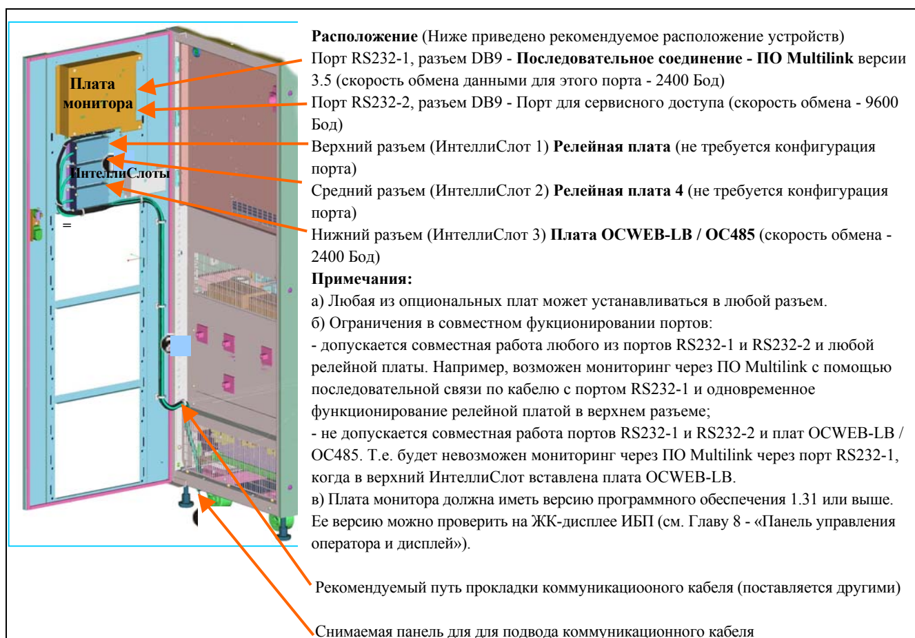
Рисунок 9.4 – Расположение коммуникационных опций и соединений
