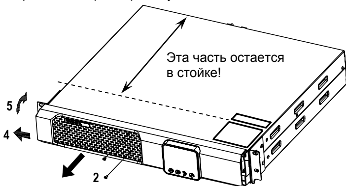
Рис. 22. Снятие лицевой крышки ИБП
